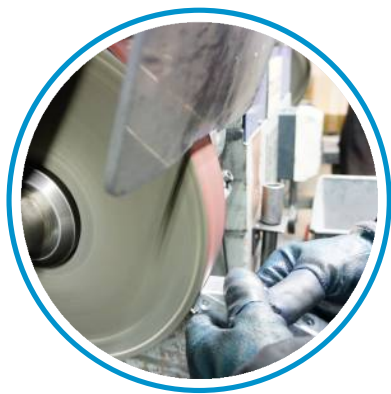
ACABAMENTO DE SUPERFÍCIE SURFACE FINISHING
